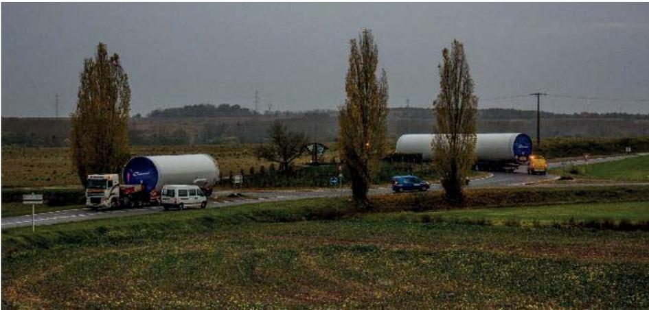
Figure 12: Transport des tronçons de mât des éoliennes
